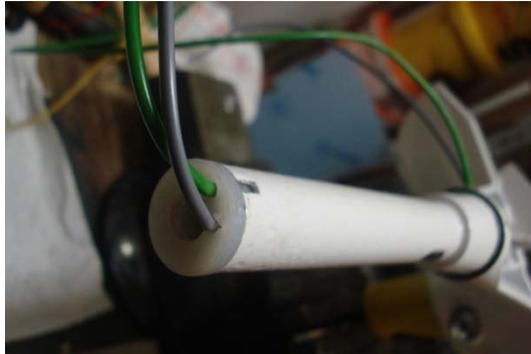
17.) Kabel (+ und -) durch den Lenker führen. Entsprechende Welle/Hülse einbauen und befestigen. Die Kabel entsprechend ablängen, mit einem Anschluss versehen und am Klemmbrett aufstecken bzw. die Masseleitung auf einen Massepunkt führen.
