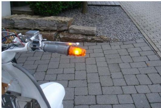
18.) Funktionsprüfung. Alle elektrischen Verbraucher auf Funktion prüfen und Lenkkopfabdeckung montieren.
