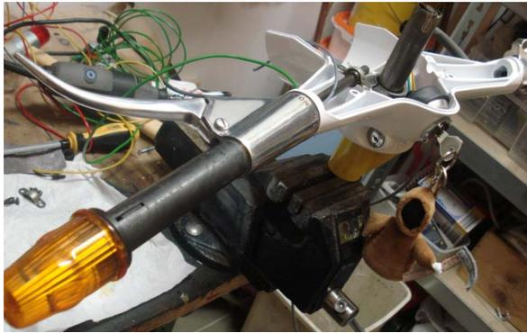
16.) Schalt-, Gaswelle und Blinkeraufnahme in die entsprechende Gas-/Schalthülse einschieben und mit kleinen Blechschrauben befestigen. Achtung: Nicht vergessen - die Griffgummis müssen davor montiert werden. Danach ist dies nicht mehr möglich!
